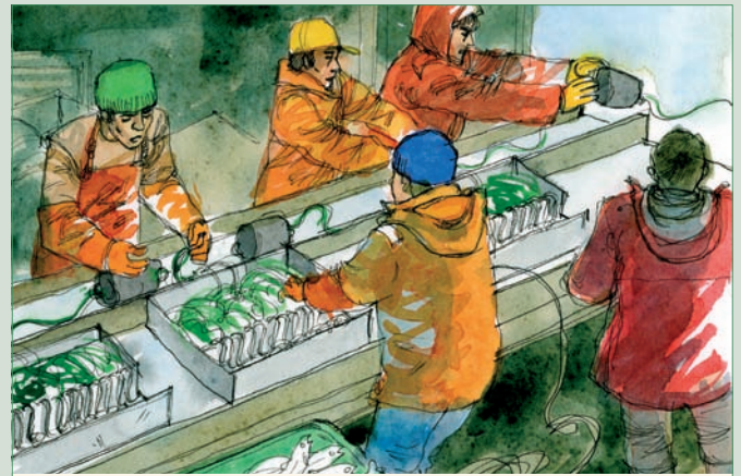
圖2 在投繩操作台上推出沉子及利用金屬板為底的餌鉤箱來減少張力，以增加釣繩的沉降速率
