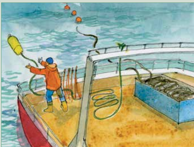
Figura 2. Líneas espantapájaros deberían ser desplegadas antes de que el primer anzuelo esté calado.
