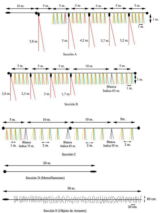
Figure 2. Esquema de los segmentos A, B, C, D y E de la línea espantapájaros. Para cada sección se indica su longitud y para las secciones A, B y C (i.e. sección aérea) se muestra la ubicación de los streamers y el espaciado entre los mismos. Los puntos negros en la línea indican la ubicación de un destorcedor (2/0). Para la sección E se indica el espaciado entre las cintas plásticas y la longitud de las mismas.
