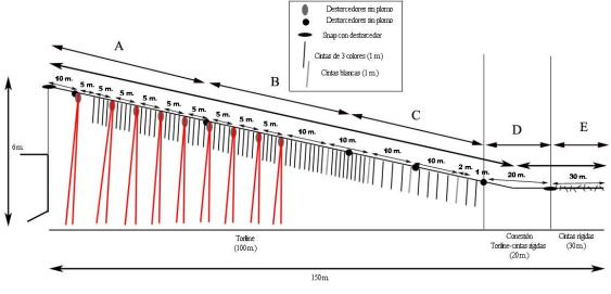
Línea Espantapájaros (Secciones A -B-C-D-E)
