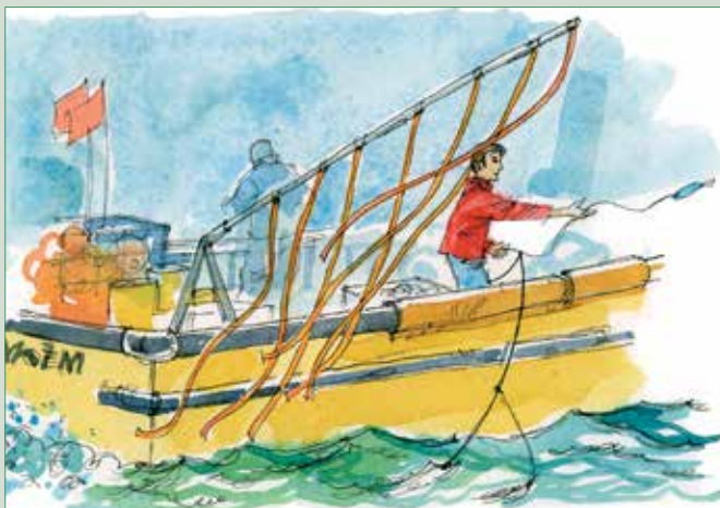
Figura 1. Lanzando anzuelos con carnada hacia la proa y cerca del casco de la embarcación permite que se hundan antes de pasar la popa de la embarcación.
